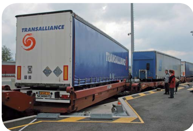
Es gira la safata per alinear-se amb el vagó i es comprova que el semiremolc queda ben fixat, en pocs minuts
