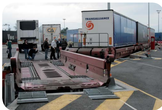
Un mecanisme instal·lat a la terminal aixeca i gira les safates dels vagons perquè es puguin carregar lateralment de forma simultània
