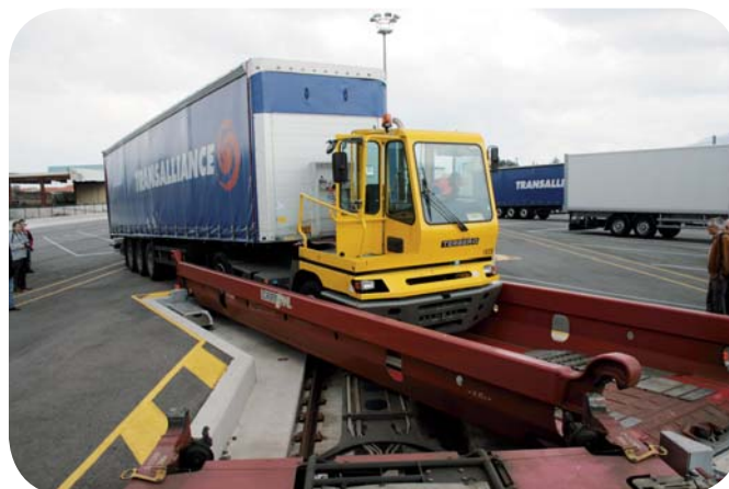
Una tractora de maniobres col·loca el semiremolc sobre la safata dels vagons especials de LorryRail
